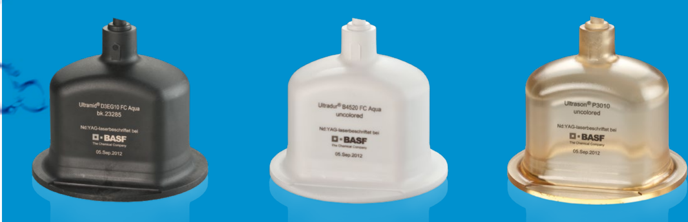
Abb. 3: Ultrasonic® Fatigue Tester aus Ultramid® D3EG10 FC Aqua (links), Ultradur® B4520 FC Aqua (Mitte), Ultrason® P3010 (rechts)
