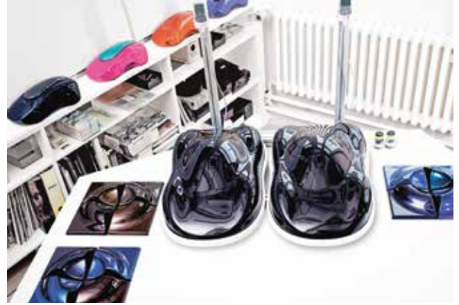
Bild 4. Funktionale Farbpigmente von BASF helfen, die Wärmestrahlung zu reflektieren. Produkte heizen sich nicht so schnell auf. Bei der im Bild gezeigten Versuchsanordnung wird der Unterschied im Temperaturanstieg sichtbar gemacht
