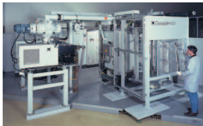
Bild 4. Sputter-Durchlaufanlage DynaMet 4V zur vollautomatischen Vakuum-Beschichtung von Reflektoren
