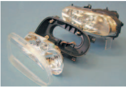
Bild 1A. Frontscheinwerfer: vorn - Aufbau aus Klarsichtscheibe, Beleuchtungseinheit (Reflektor aus metallisiertem Ultrason E, Lampen) und Gehäuse; hinten - montierter Scheinwerfer, aufgebaut aus teilprofiliertes Abdeckscheibe, Blende (metallisiertes Ultradur B 4520), Beleuchtungseinheit und Gehäuse
