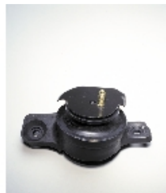
In Japan haben sich die Motorlager aus PA und Gummi bereits bewährt.
