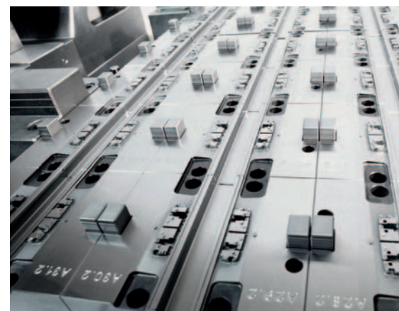
Kurze Zyklen durch schnelles Drehen: Das 32+32-fach-Werkzeug für ein 2K-Rasiererteil sitzt auf einem 900er-Drehteller (Foto: Braunform)
