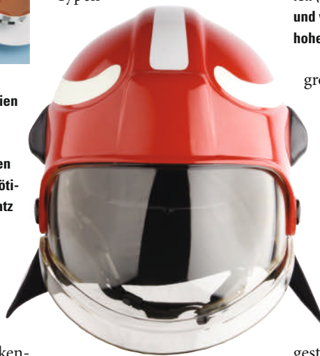
Bild 10. Im Visier des Feuerwehrhelms ist die hochtransparente PESU-Variante Ultrason E 2010 HC im Einsatz. Hier kommt die Kombination aus hoher Temperaturbeständigkeit, inhärenter Brandsicherheit, hoher Transparenz und Bruchsicherheit zum Tragen. Bei dieser Spezialtype gelang es, die typische gelbe Eigenfarbe des Kunststoffes deutlich zu reduzieren und so eine hohe optische Reinheit zu erzielen
