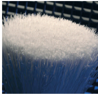
Bild 8. Gefällte Polyarylsulfone weisen Poren mit sehr gut kontrollierbaren, geringen Durchmessern auf und finden – hier ein Hohlfaserbündel – in der Mikro- und Ultrafiltration immer häufiger Anwendung. Die hohe Temperatur- und Hydrolysebeständigkeit erlaubt eine wiederholte Sterilisierung
