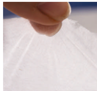
Bild 9. Das tschechische Unternehmen Elmarco verwendet den BASF-Hochleistungskunststoff Ultrason E2020 P SR, um Vliese herzustellen (links). Diese Schichten aus dünnen Fasern dienen als Zähmodifikator und verleihen Carbonfaser-verstärkten Composites (rechts) besonders hohe Festigkeit
