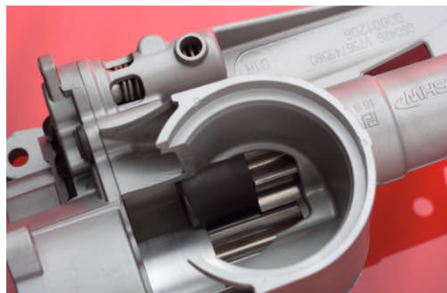
Bild 3. Ölpumpenkolben von SHW (Schwäbische Hüttenwerke Automotive): Ein besonders bezüglich Gleitreibung optimiertes Polyethersulfon der BASF wird demnächst unter dem Namen Ultrason E 2010 C2 TR offiziell ins Sortiment aufgenommen (TR: Tribologie); seine Verschleißrate liegt – ohne den Einsatz von Schmiermitteln – um ein Hundertfaches unter der von klassischem PESU
