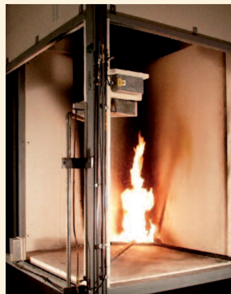
Abb. 2: Laut EU-Norm Pflicht: der Single Burning Item Test, mit dem Brandverhalten, Rauchentwicklung und brennendes Abtropfen überprüft werden.
