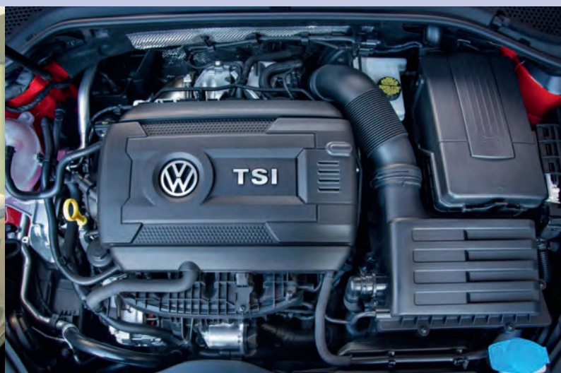
Geräuschdämpfung im Volkswagen-Motor EA888, North America. Foto: VW/BASF
