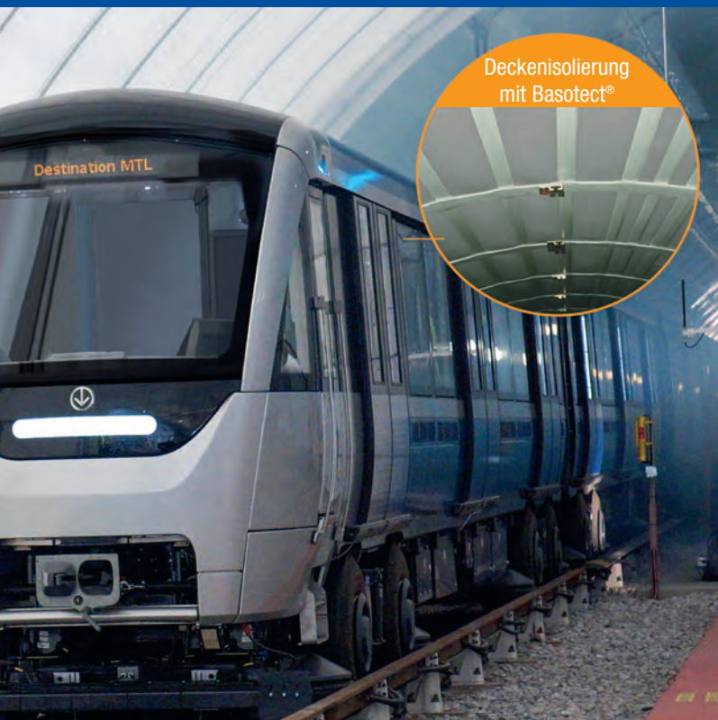
Wärmedämmung und Schalldämpfung im Deckenbereich von U Bahn-Wagen in Montreal, Kanada. Foto: Bombardier, Inc.
