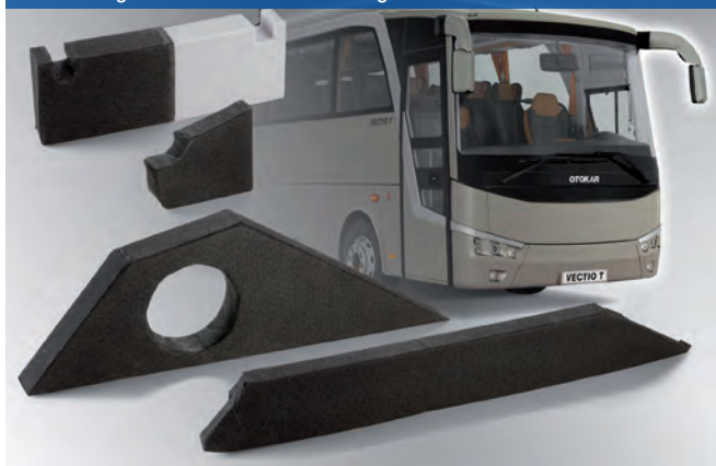
Dämmung von Motorraum und Fahrgastzelle in Bussen
