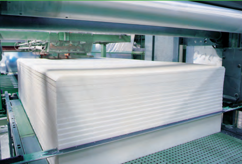
Zuschneiden von Basotect®-Platten
