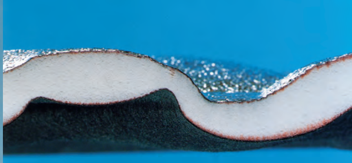
Formteil, kaschiert mit Aluminiumfolie und Vlies
