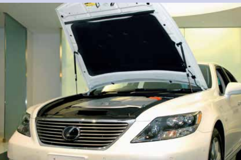
雷克萨斯LS系列发动机罩衬。图：丰田/巴斯夫
