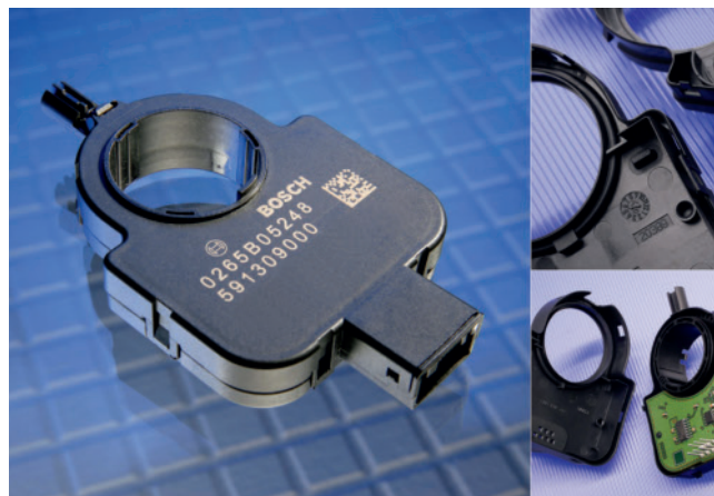
Bild 4. Das filigrane und dünnwandige Kunststoffgehäuse des neuesten Lenkwinkelsensors von Bosch besteht aus Ultradur B4300 G4 LS High Speed, einer laserbeschriftbaren und mit 20 % Glasfasern verstärkten Version des besonders fließfähigen PBT
