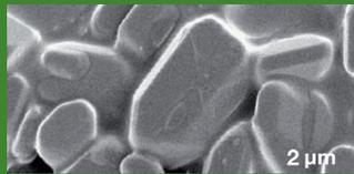
*Cuadro de barrido de microscopio electrónico donde se observa la adherencia de una aplicación de Initium®, tornándose una película de depósito sobre el tejido vegetal.*
