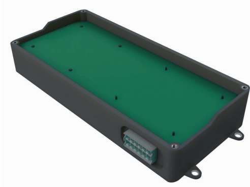
Bild 5. Vernietete Leiterplatte in einer Battery Disconnect Unit © BASF
