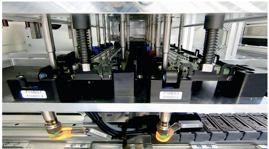
Bild 3. Vernietung von Leiterplatten mit dem BHS-Hot-Air-Verfahren © bdtronic
