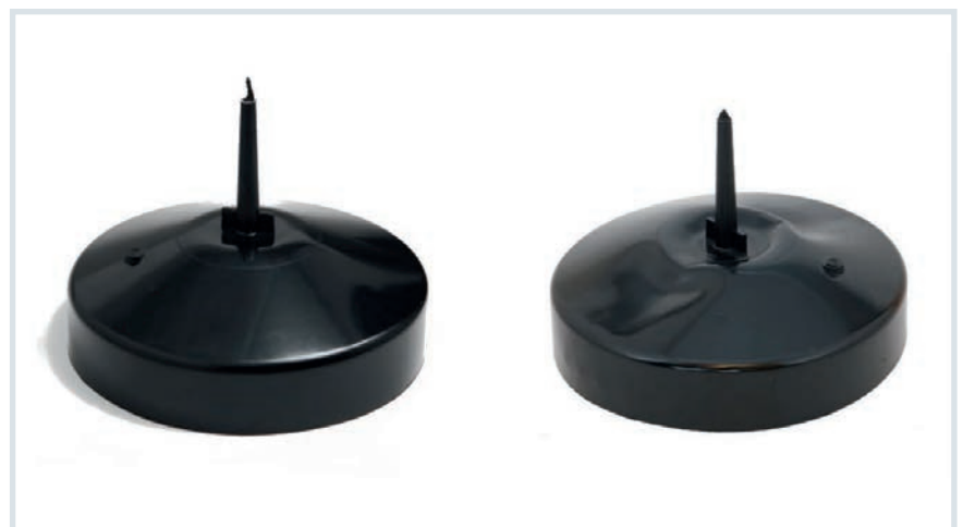
Bild 4. Formteil, links bei ausreichend langer Kühlzeit, rechts bei zu geringer Kühlzeit (© BASF)
