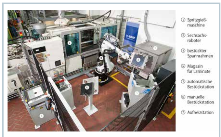
Bild 3. Mit der Ultracom-Fertigungszelle kann für die Verarbeitung thermoplastischer Verbundwerkstoffe ein vollautomatisierter Prozess mit spritzgießtypischem Zyklus realisiert werden (© BASF)
