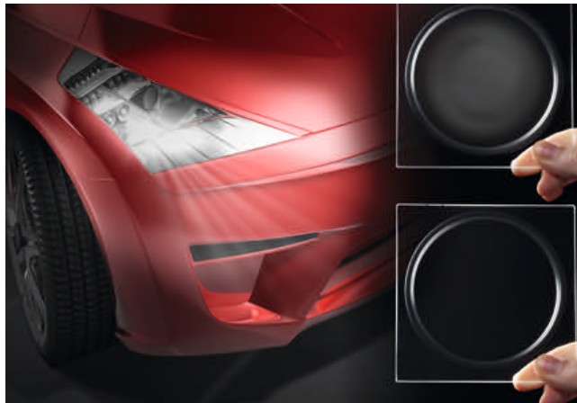
Bild 5. Hochglänzende, metallisierte Scheinwerfer-Zierblenden sind eine wichtige PBT-Anwendung: Ein neu entwickeltes PBT zeichnet sich im Langzeitbetrieb bei 160 °C durch extrem geringe Ausgasungen aus, die bei Standard-PBT zur Trübung der Scheinwerferlinse führen können
