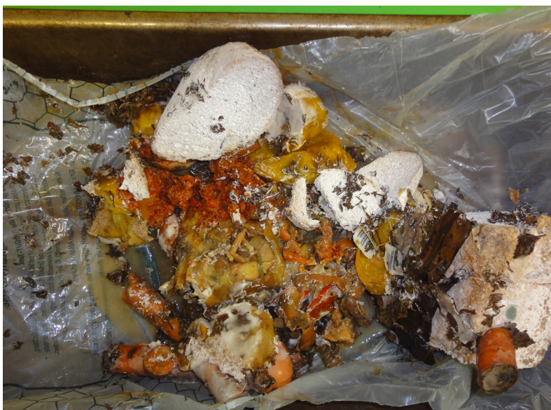
Abbildung 4 Küchenabfall nach 14 Tagen in einem ecovio®-Beutel mit belüftetem Vorsor- tiergefäß
