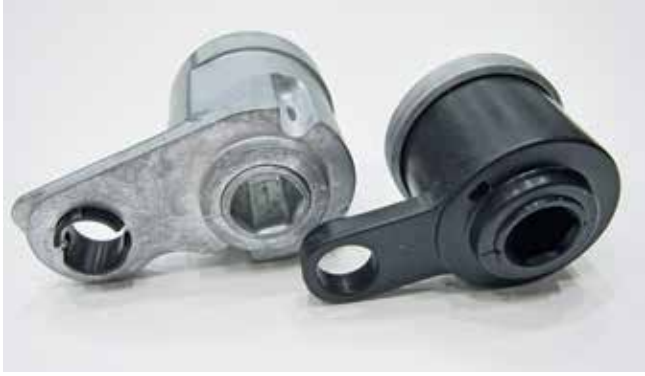
Bild 1. Metallersatz im Automobil: Das Dämpfungselement aus einem Polyamid mit 60% Glasfasergehalt (rechts) wiegt rund 50% weniger als die bisherige Ausführung in Zink (links)
