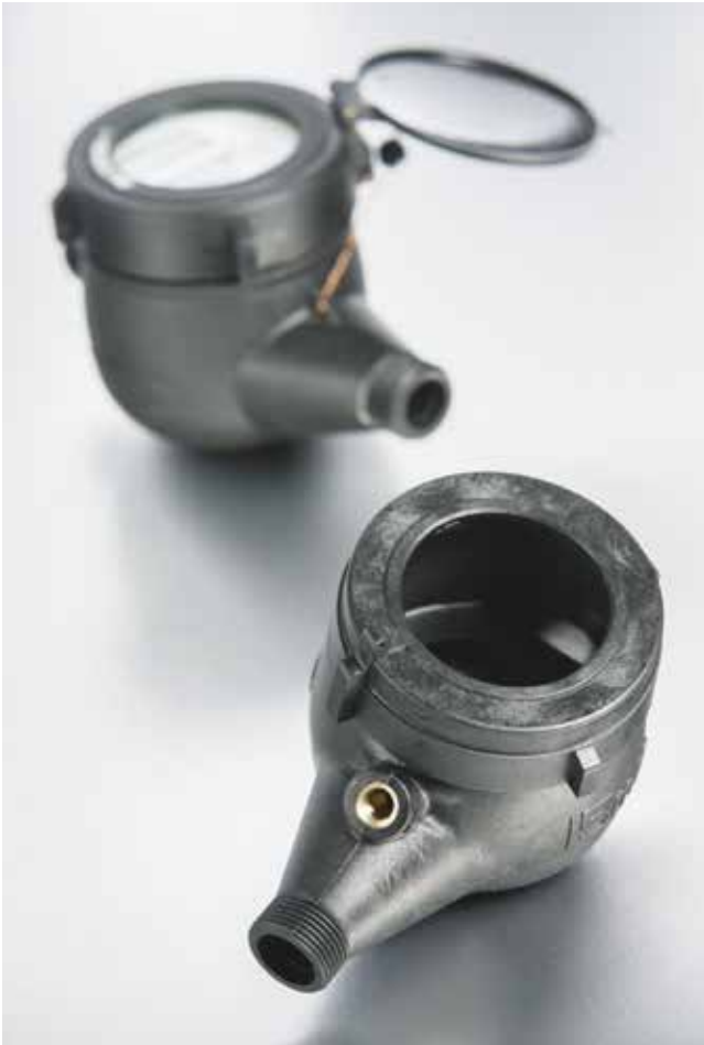
Bild 2. Ein Beispiel für Polyamid, das sich aufgrund der guten Chemikalien- und Hydrolysebeständigkeit für Bauteile mit Kontakt zu Trinkwasser eignet, ist Ultramid D3EG10 FC Aqua. Die Aqua-Varianten eignen sich zum Beispiel für den Ersatz bleihaltiger Legierungen in Wasserzählergehäusen
