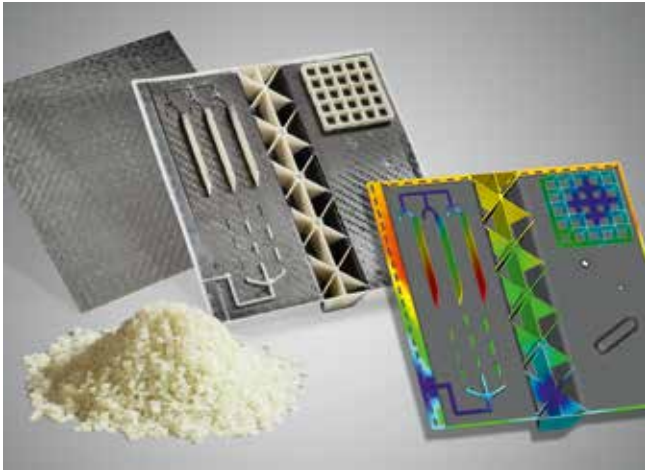
Bild 3. Mit Laminaten und Tapes lassen sich im Spritzgießen komplexe Bauteile fertigen, die an genau definierten Stellen über eine sehr hohe mechanische Verstärkung durch Endlosfasern verfügen. Im Bild ein multifunktionaler, 360 mm x 360 mm großer Testkörper, mit dem sich zahlreiche Merkmale und Probleme der Composite-Herstellung nachstellen lassen
