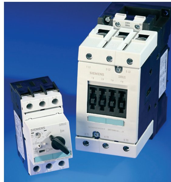
Bild 4. Motorschutzschalter (klein) und Schaltschütz (groß): Für das schwarze Gehäuse des Motorschutzschalters verwendet Siemens ein mit rotem Phosphor als Flammschutz ausgerüstetes Polyamid 66. Im Fall des großen Schalters ist das PA 66 mit einem Duroplasten kombiniert; die hellen Abdeckungen sind in flammgeschütztem, glasfaserverstärktem PA 6 und in PBT laserbeschriftbar realisiert
