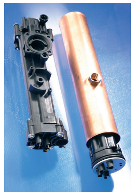
Bild 1. Bisheriges Konzept: Heizblock mit Kupfermantel (rechts), Monoheizblock aus glasfaserverstärktem Polyamid 66 (links)
