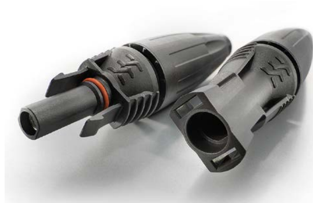
Bild 5. Eine typische Anwendung für mit Phosphor flammgeschütztes Polyamid sind Steckverbinder für Photovoltaikanlagen; Ultramid A3X2G5 erfüllt mit seiner hohen Schlagzähigkeit bei -35°C die UL-Norm 1703 (Bild: Weidmüller)
