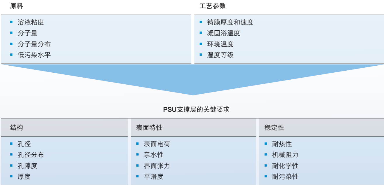
图 3：原材料特性及工艺参数对PSU支撑层性能的影响
