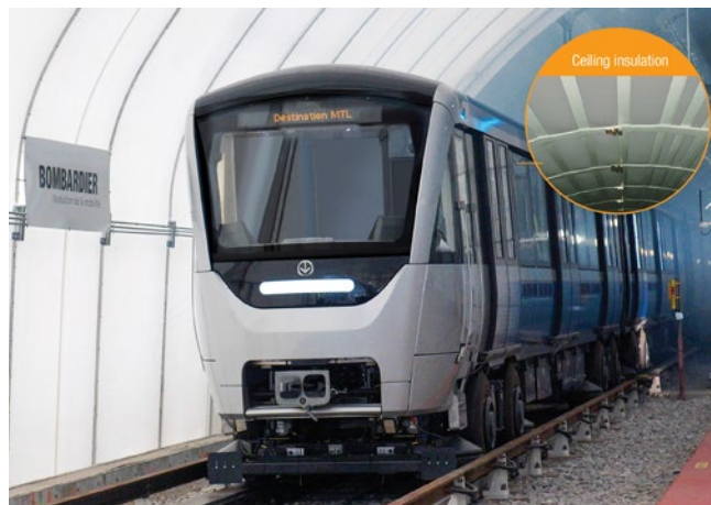
Der Melaminharzschaumstoff Basotect® von BASF kommt für die Wärme- und Schalldämmung im Deckenbereich von 468 neuen U-Bahn-Wagen zum Einsatz, die Bombardier für die Metro in Montreal, Kanada, baut. (Foto: Bombardier, Inc., 2014)
