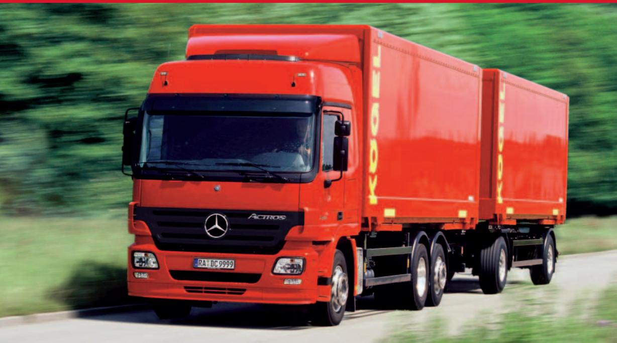
Alle Nutzfahrzeuge über 6 t Gesamtgewicht von DaimlerChrysler besitzen eine als Bluetec bezeichnete Abgasreinigung auf SCR-Basis (Foto: DaimlerChrysler)
