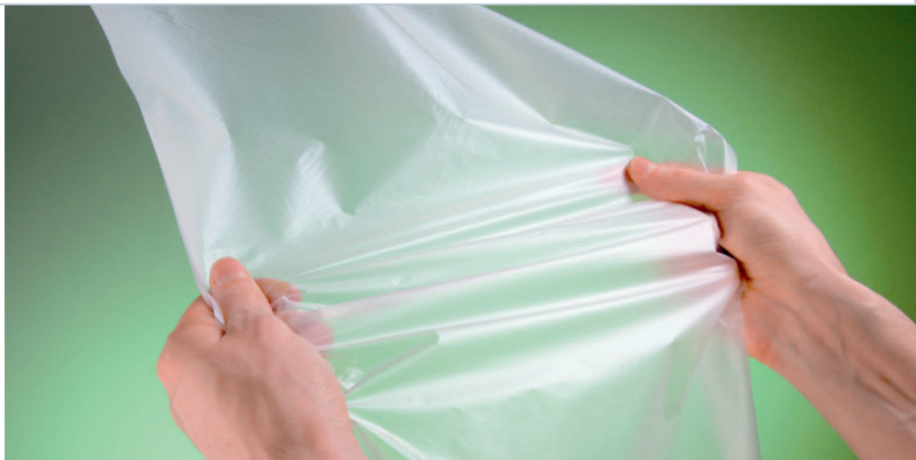
Bild 6. Folien aus Ecovio sind durch den Anteil an Ecoflex wasserfest und reißfest
