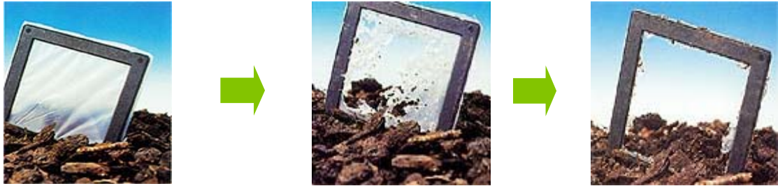
图 3：以矿物原料为基础的生物可降解塑料Ecoflex® 可达到日益严格的国际可降解性和可堆肥性标准要求：以上从左至右为 4 周中Ecoflex® 在 55 堆肥环境下逐渐分解的图示。
