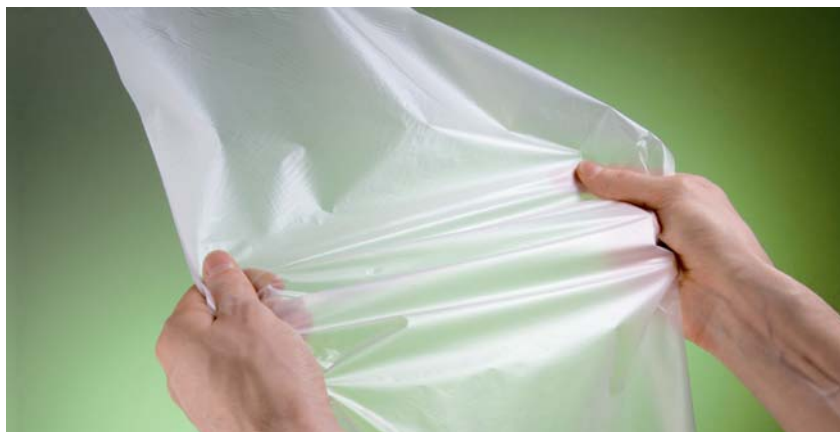
图 6: 因为含有Ecoflex ® , 用Ecovio ® 制成的薄膜防水性、耐撕裂性都有所提高。
