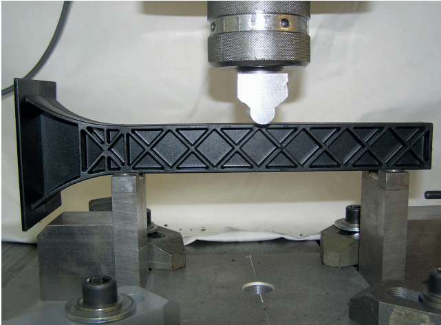
Bild 3. Ein 3-Punkt-Biegeversuch zeigte, dass die maximal notwendige Brucharbeit bei den Ultramid-XP-Typen die von vergleichbaren PA-6- und PA-66-Typen übersteigt © BASF
