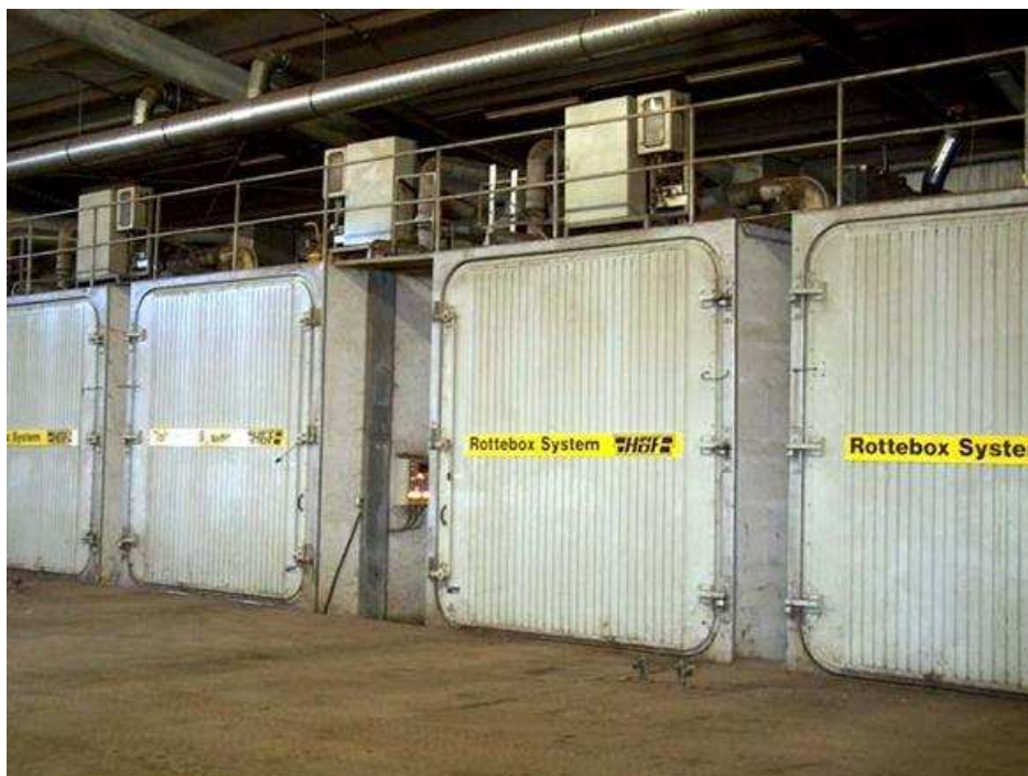
Abb. 12: Foto: Verfahrensschema der Boxenkompostierung (System HerHof)
