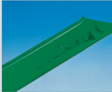
Farbschlieren infolge Verunreinigung im Heißkanal
