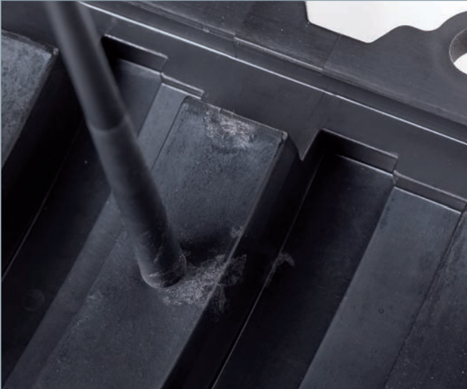
Erkalteter, abgerissener Düsenzapfen bei direkter Anbindung eines Deckels über Stangenanguss (glasfaser-verstärktes Ultradur®)
