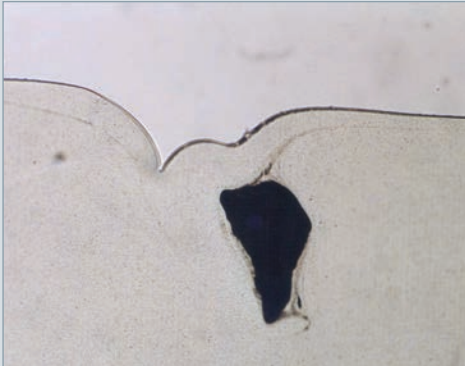
Ablagerung aus einem Heißkanal nach Maschinen- stillstand (Ultraschall)
