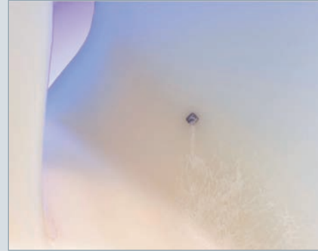
Dunkle Punkte verursacht durch Fremdgranulat
