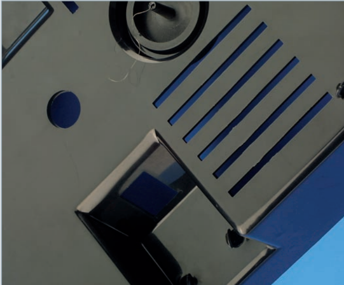
Auswerfer durchstossen das Formteil aufgrund einer zu kurzen Kühlzeit.
