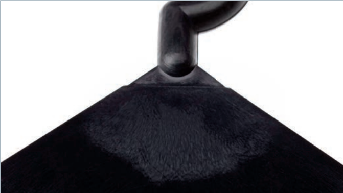
Matte Stellen wegen eines Querschnittübergangs
