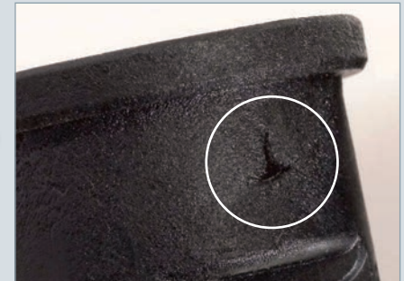
Das Füllbild zeigt die Zusammenflussstellen verschiedener Schmelzeströme.
