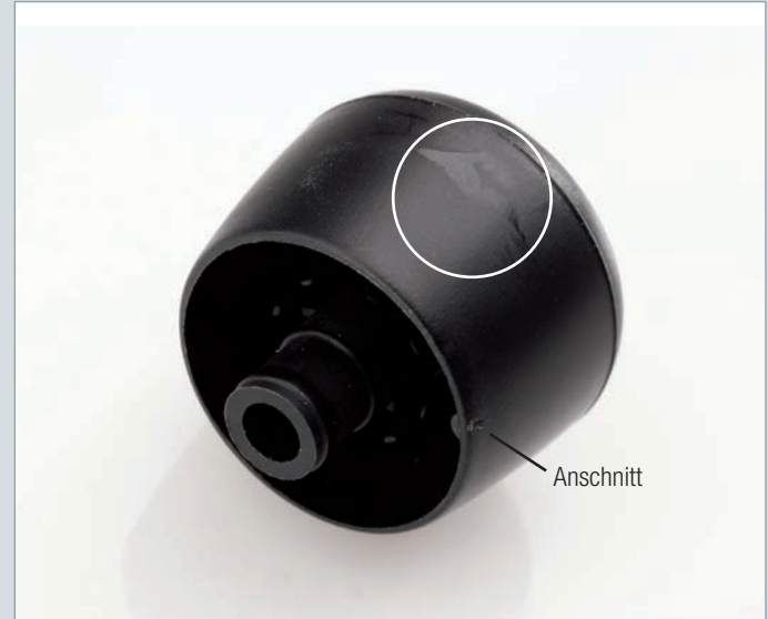
Kalter Pfropfen in einem Formteil aus glasfaser-verstärktem Ultradur®
