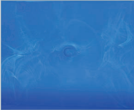
Farbschlieren durch Verwendung eines ungeeigneten Masterbatches
