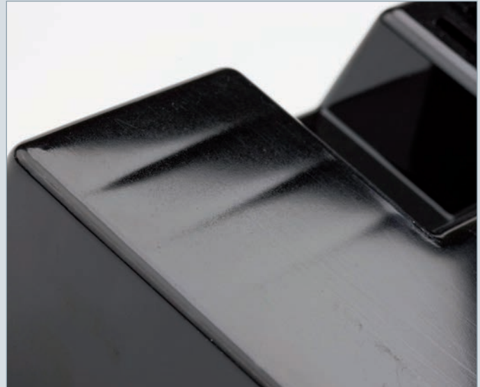
Einfallstellen infolge von Rippen
