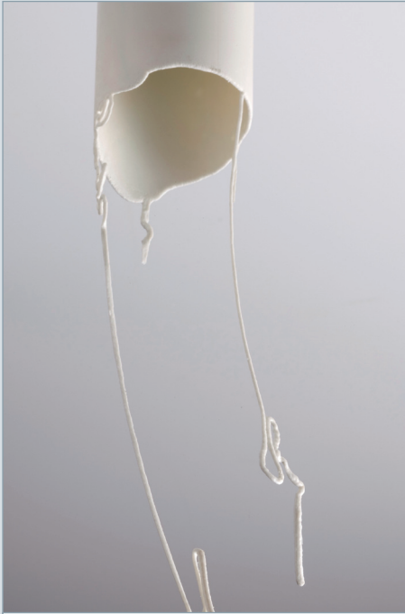
Freistrah an einer Hülse verursacht durch eine dreifach Anbindung über Punktschnitt
