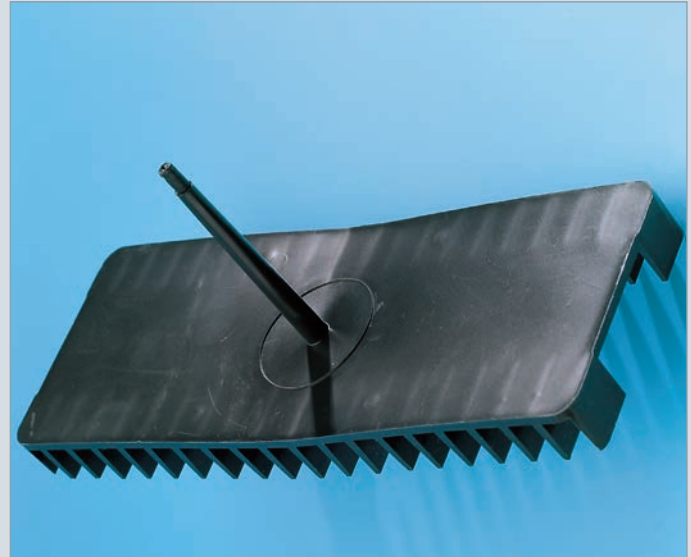
Entformungsprobleme verursacht durch Überladung (zu hoher Nachdruck)
