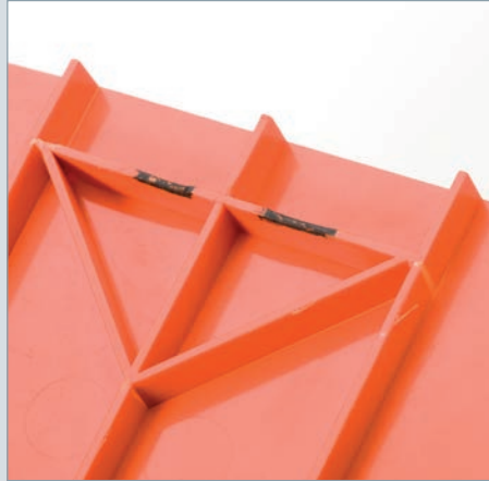
Diesel-Effekt in einer Rippe wegen fehlender Entlüftung
