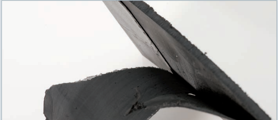
Delamination wegen zu hoher Einspritzgeschwindigkeit (Ultramid T)
