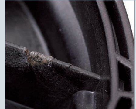
Diesel-Effekt in einer Rippe wegen fehlender Entlüftung
