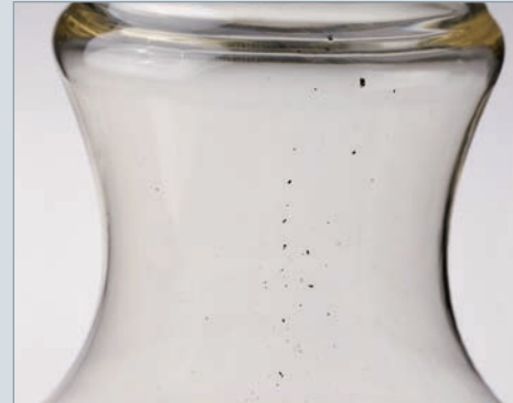
Verschmutzungen in einer Flasche aus Ultraschall wegen „toter“ Ecken in der Plastifiziereinheit
