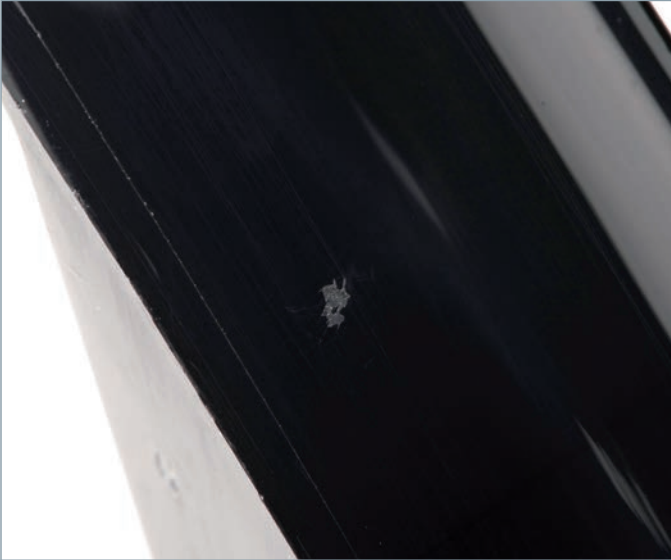
Oberflächenfehler verursacht durch einen abgerissenen Anschnitt (unverstärktes Ultradur)
