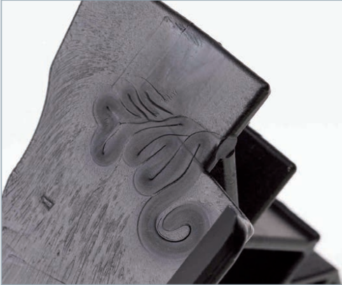
Freistrahл aufgrund ungünstiger Anschnittposition
