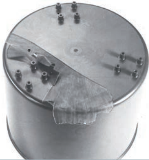
Delamination verursacht durch eine zu hohe Einspritzgeschwindigkeit (mineralverstärktes Ultramid®)
