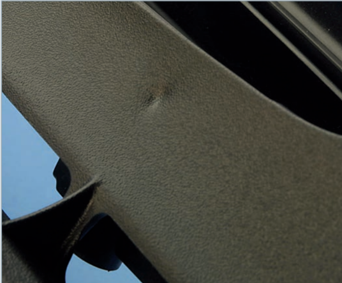
Einfallstelle im Bereich einer Masseanhäufung: nicht kunststoffgerechtes Design eines Einschraubdoms
