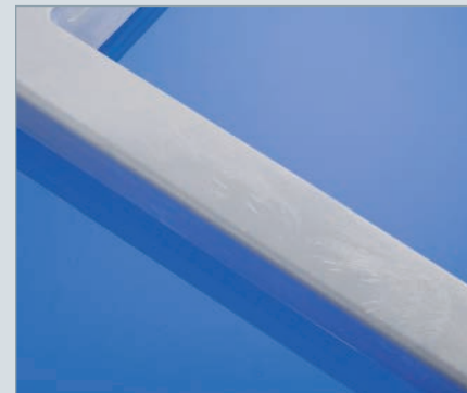
Thermisch verursachte Schlieren
