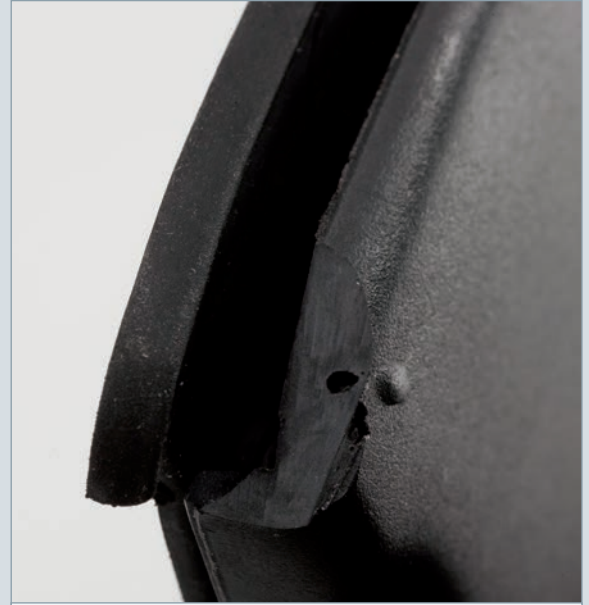
Eingeschlossene Luft verursacht durch ungünstige Formteilgestaltung
