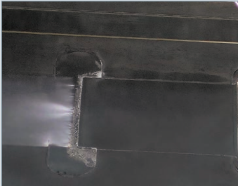
Werkzeugbelag (Formbelag) am Fließwegende wegen fehlender Entlüftung
