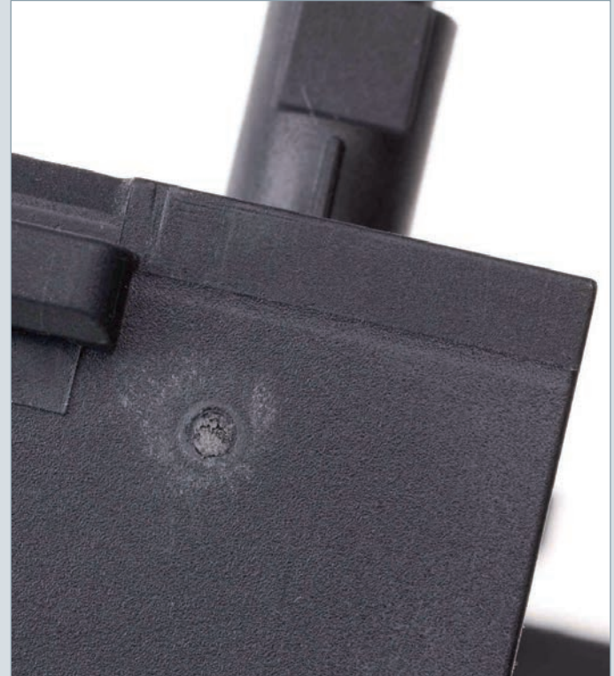
Matte Stellen im Bereich des Anschnitts wegen hoher Scherung
