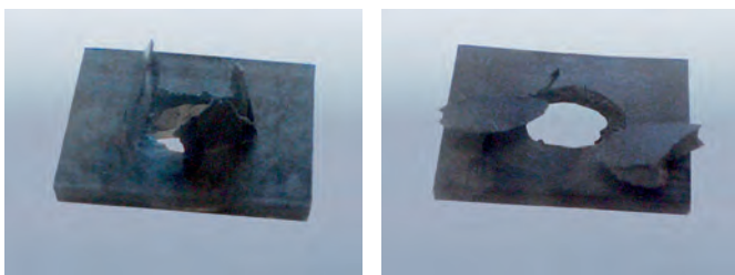
Abb. 12: Duktileres Bruchbild nach erfolgtem Durchstoßversuch an einer Platte aus Ultramid® Structure A3WG10 LFX (links, Scharnierbruch) und PA66 GF50 (rechts, Splitterbruch).
