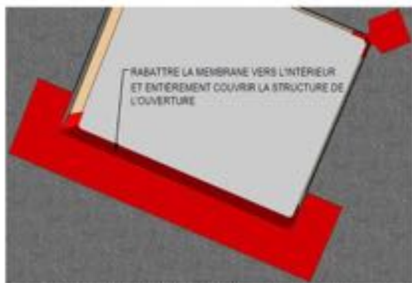
D - RABATTRE LA MEMBRANE D'ÉTANCHÉITÉ DANS L'OUVERTURE
